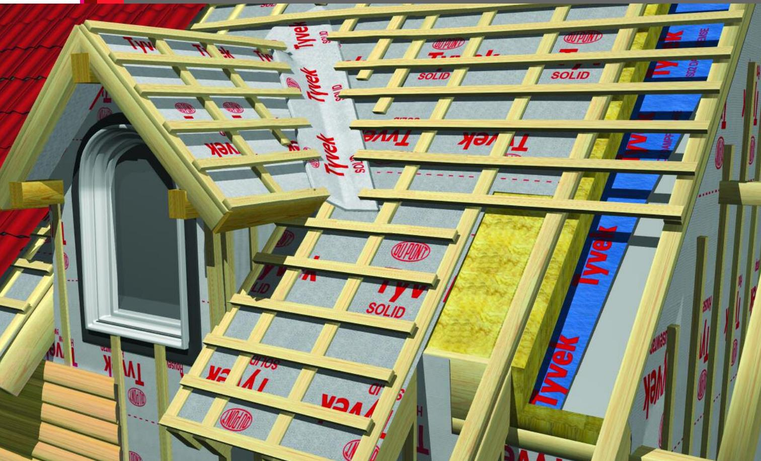
**Рис.1** Устройство утепленной мансарды
