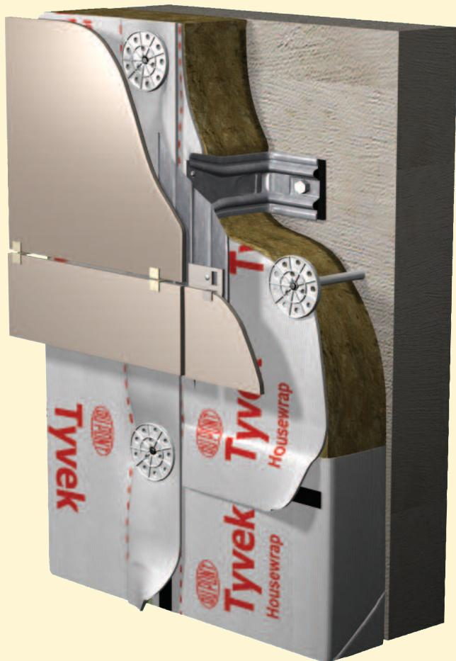
Рис. 9 Системы навесных вентилируемых фасадов
