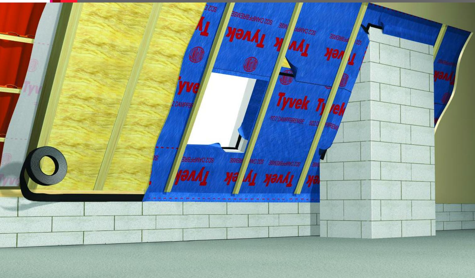
**Рис. 10** Монтаж пароизоляции
